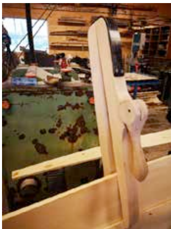
Kan vi lage 6 slike til Loggen... Materiale.. bøk? Merk beltet som holder delene sammen. Hvalbarder.
