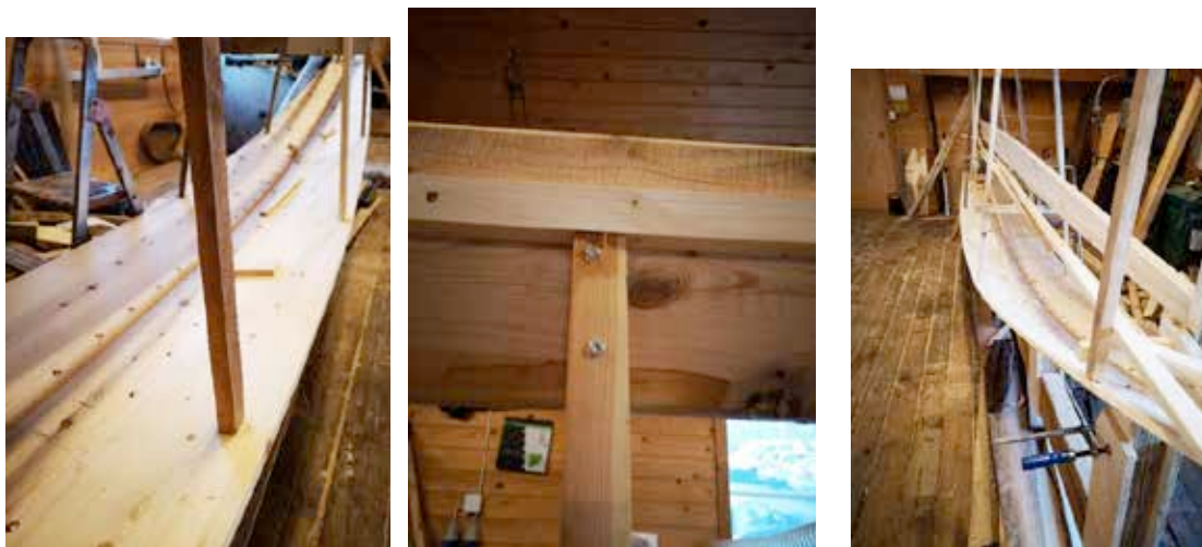
Bordgang 1 styrbord, med skoringer, etter at vinklene er justert.
