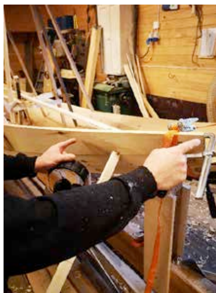
Merking av høvlekant på bordgang 3.
