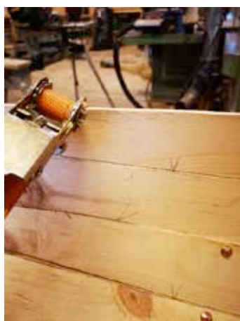
Her kommer spantene merket av.. ikke korte nagler her. Vent til spantene er på plass.
